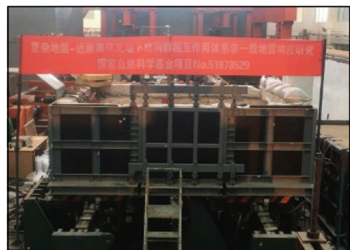
图1 模型箱构造图和实物图
