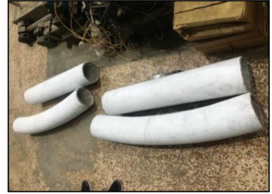
图 3 隧道模型实物图
