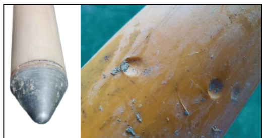
图 16 改进探头(圆角)刺入试验
