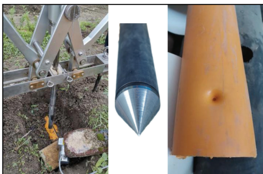
图 15 常规探头(尖角)刺入试验
