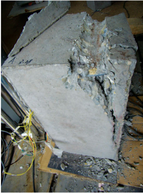
图7 偏心疲劳荷载作用下试件破坏
