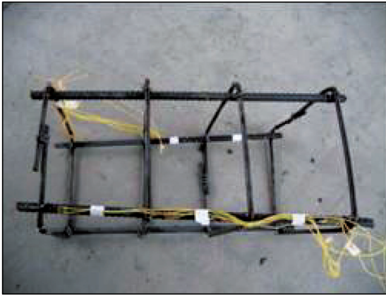
图 3 实扎钢筋笼应变片示意
