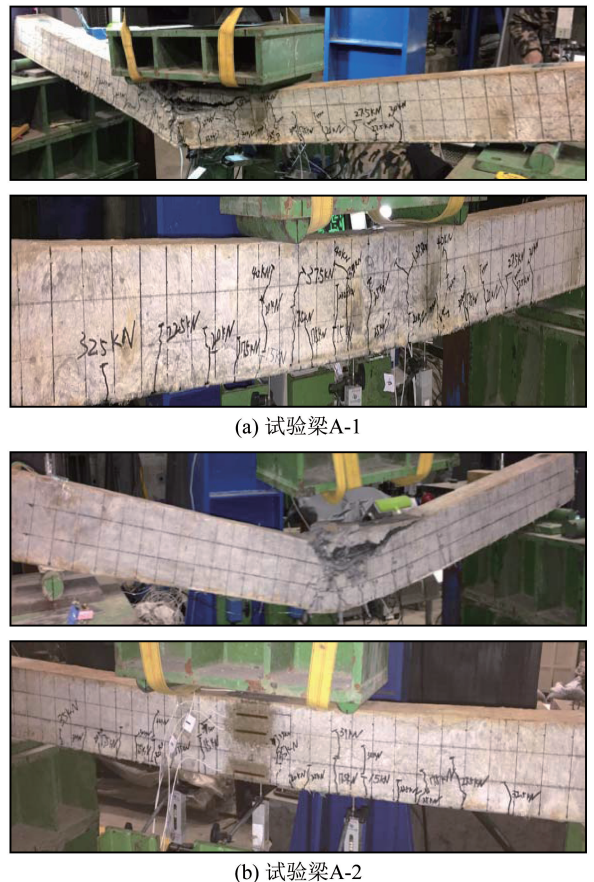
图4 钢筋混凝土试验梁加载破坏形态
