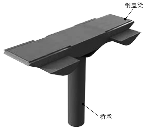
图1 桥墩三维模型图
