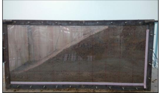
图1 振动台模型试验箱及模型
