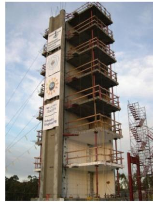
图 1 某足尺 7 层原型测试结构
