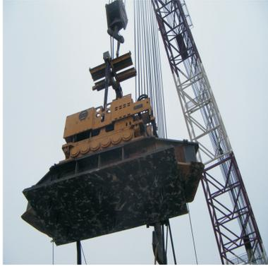
图 1 液压锤振动压实系统
