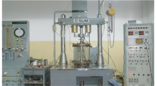
图 1 S-3-D 电液伺服中型振动三轴仪
