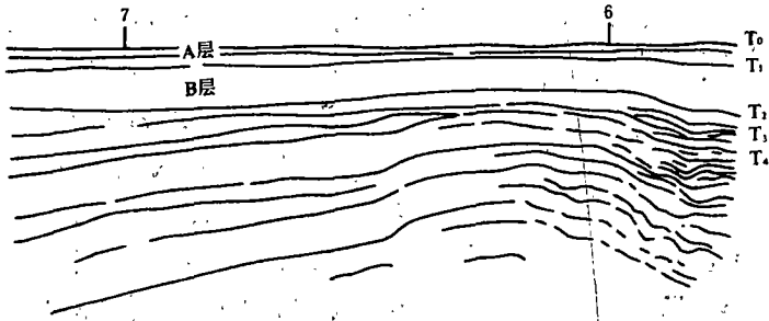
图 6 L—8 测线(6—7 测点)背斜构造剖面图
