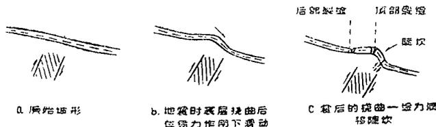
图5 斜坡地带地震挠曲—重力滑移陡坎形成过程示意图
