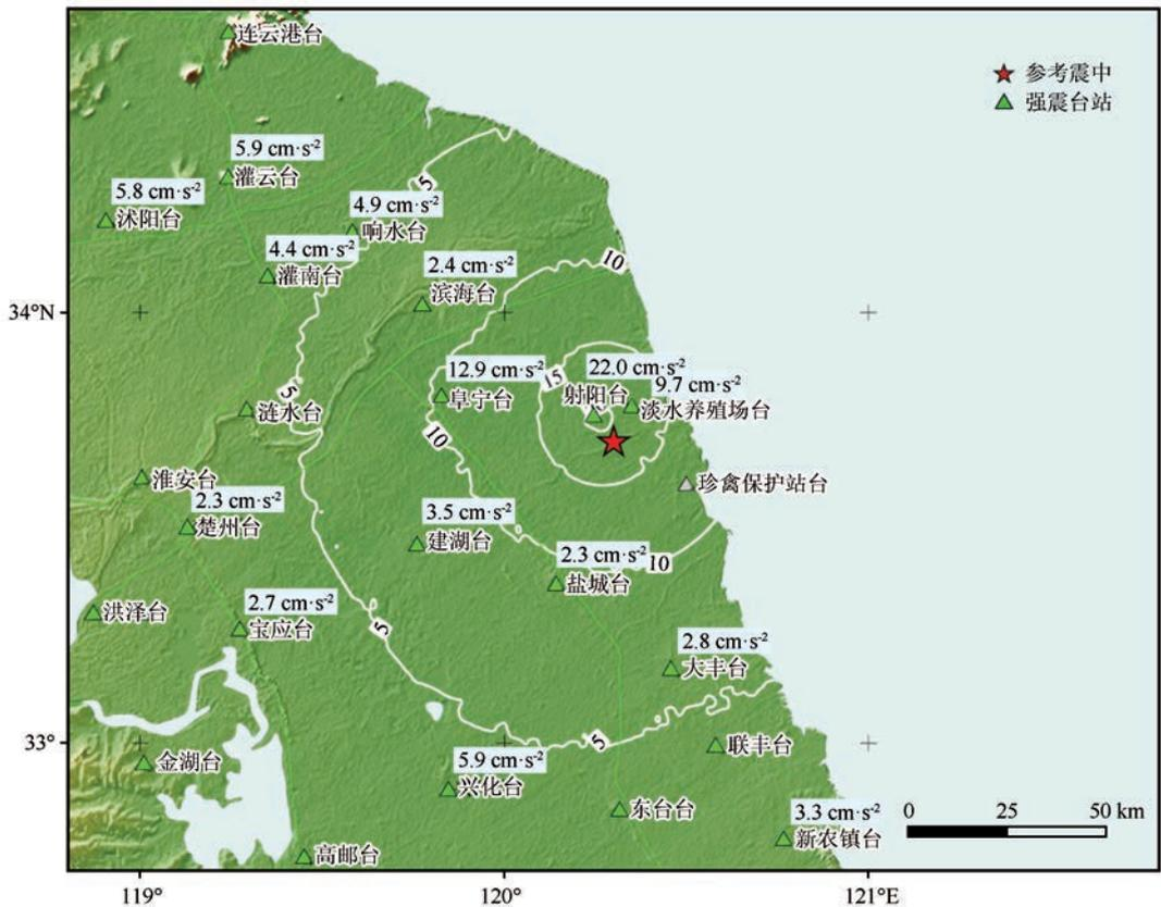
图 3 2016 年 10 月 20 日射阳 M4.4 地震 PGA 分布图
