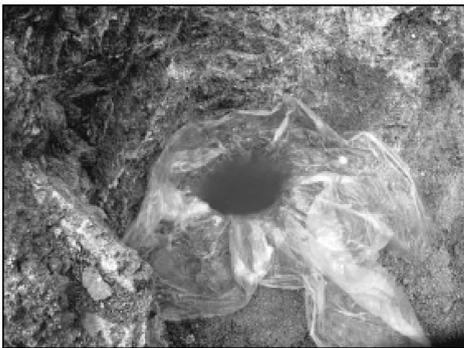
图 4 测试坑体积测量
