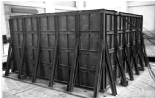
图 1 振动台试验模型箱
