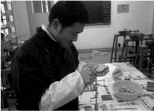
图 3 环刀法测试土体重度
