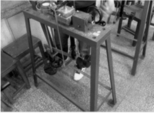
图 2 应变控制式直接剪切仪
