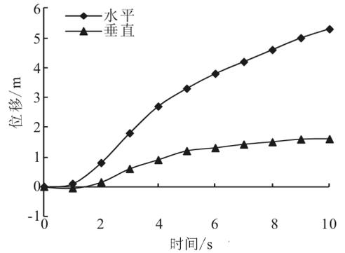
图 6 速度为 0.5 m/s,频率为 5 Hz 的正弦波时管中部位移
