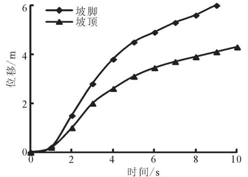
图 4 速度为 0.5 m/s,频率为 5 Hz 的正弦波加载后坡脚和坡顶位置距离地表面 10 m 深的位移与时间关系图
