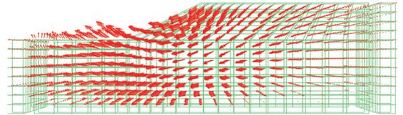
图 3 速度为 0.5 m/s,频率为 5 Hz 的正弦波加载后振动 10 s 时的位移向量图
