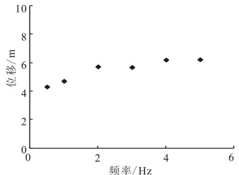
图 8 速度幅值为 1.0 m/s 的正弦波振动 10 s 时管节点位移与速度频率关系图
