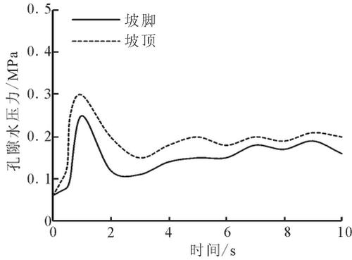
图 5 速度为 0.5 m/s,频率为 5 Hz 的正弦波时坡脚和坡顶下距离地表面 10 m 深度的最大孔压时程图
