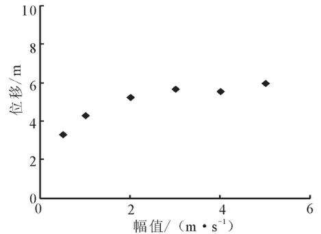
图 7 频率为 0.5 Hz 的正弦波振动 10 s 时管节点位移速度幅值关系图
