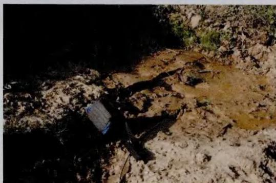
(d) 永光村西喷沙冒水及地表裂缝
