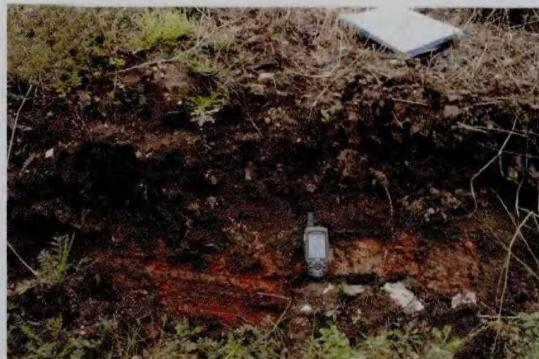
(c) 安家山滑坡后壁上出现的水平擦痕
