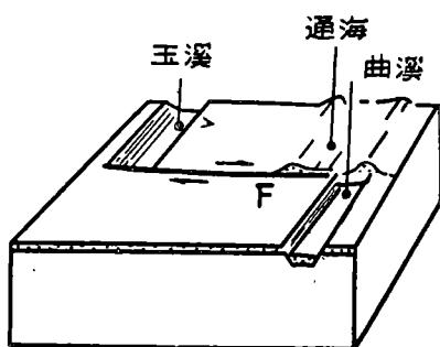
图3 曲江断裂右旋运动
