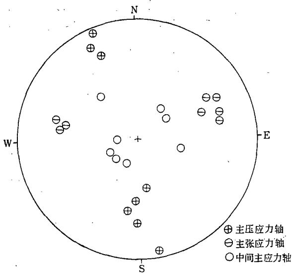
图4 通海地震裂缝带所显示的主应力轴投影图
