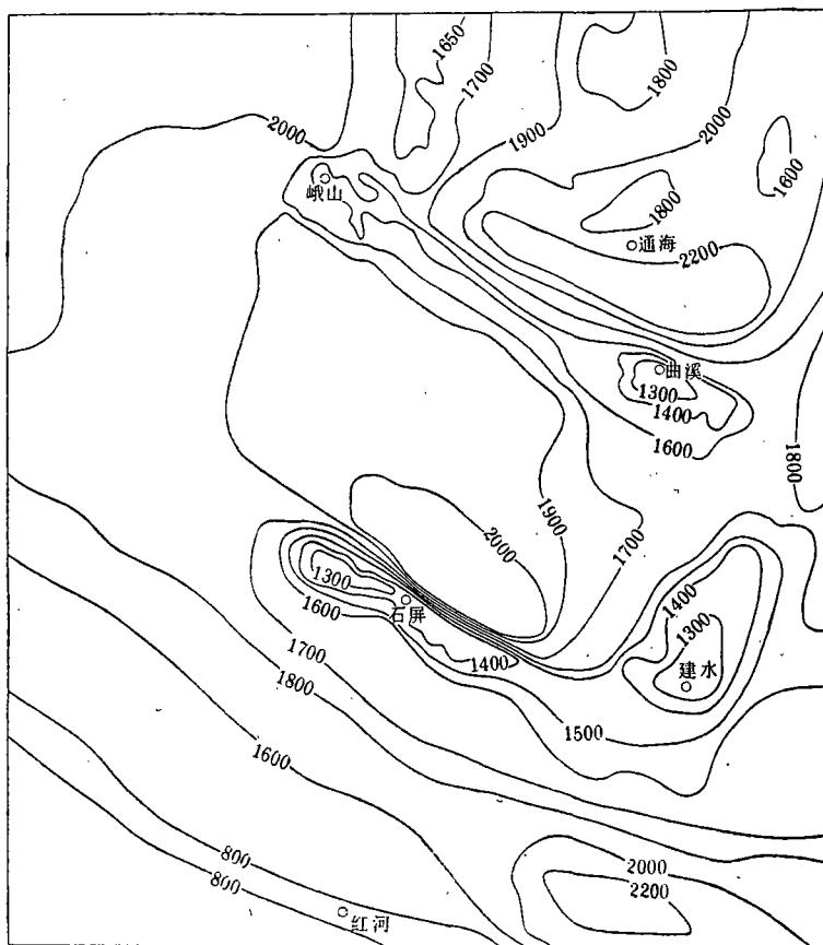
图2 第四纪垂直构造形变等值线图
