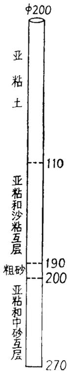
图5 试验用井地质剖面图
